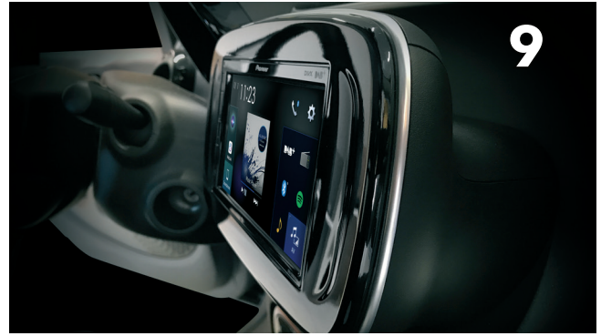
Put the frame with the chrome trim on Mettez le cadre avec la pièce chromée dans le tableau
