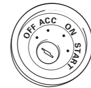
Замок зажигания, на котором предусмотрено положение ACC
