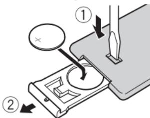
Insira a pilha CR2025 (3 V) com os polos positivo (+) e negativo (-) conforme indicado.
