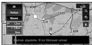
Verschil in afstand en reistijd tussen een bestaande en een nieuwe route
