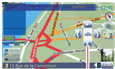
Bedienelemente zum Ändern des Neigungs- und Drehwinkels
